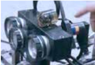
Sistema de cámara de vídeo subacuática con función Pan & Tilt (giratoria) para inspección en tiempo real.
